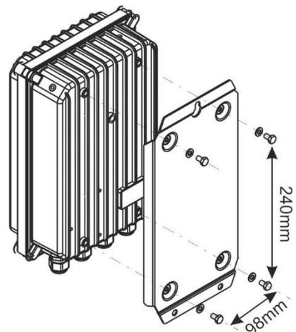
Los 4 tornillos de fijación de la puerta del equipo deben apretarse completamente (par de apriete de (<3Nm-10Nm>) para garantizar el índice de protección del equipo (IP54). Los prensa estopas que no se usen deben cerrarse por un medio que garantice al menos el mismo nivel de protección.
