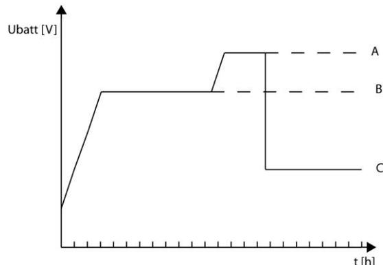
A= tensión de ecuación, B= tensión de absorción, C= tensión de mantenimiento
