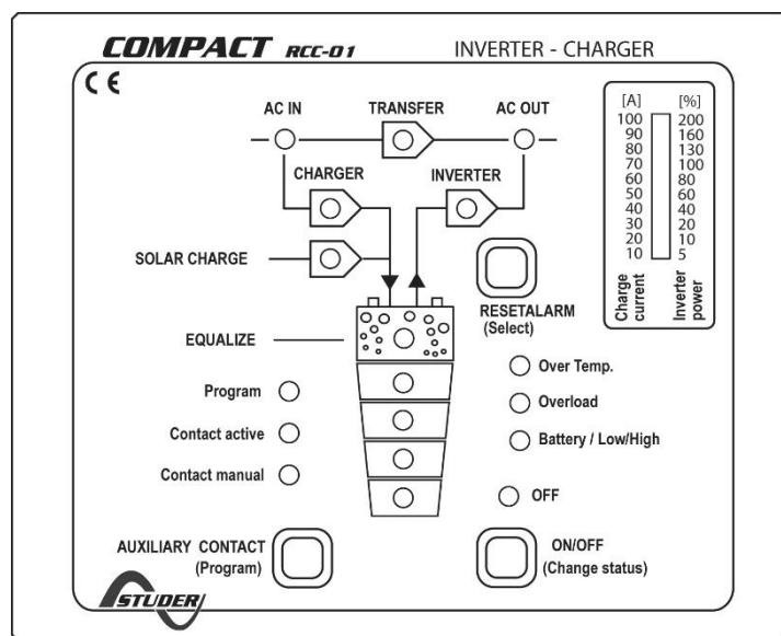
In der Fernsteuerung sind ein weiterer Hilfskontakt und ein Steuereingang eingebaut. Diese beiden Funktionen stehen über eine Steckbuchse RJ11/4 zur Verfügung.
