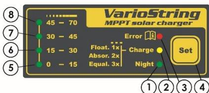
Si se mantiene pulsada la tecla "Set" (4) durante 5 segundos hasta el segundo bip sonoro el VarioString se apaga. Se volverá a activar con una orden similar de 5 segundos en el botón set.
