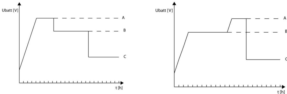
A= tensión de ecualización, B= tensión de absorción, C= tensión de flotación
