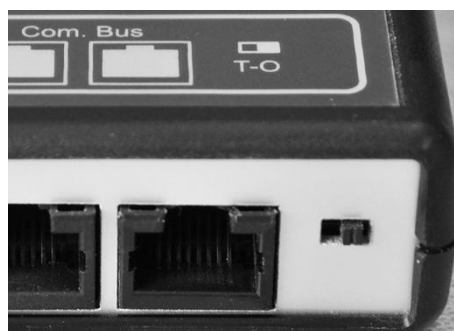
Terminación BSP desactivada (posición O)
