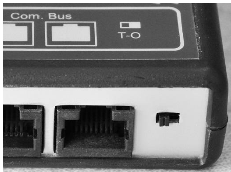
Terminación Xcom-232i activada (posición T)
